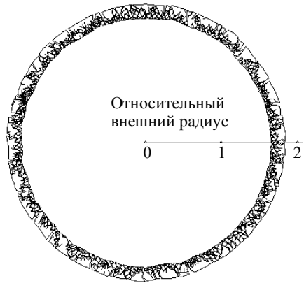
Рис. 4.15. Время t = 32 мкс. Распределение \varepsilon_{\max}^{\text{ЭКВ}} по экспоненциальному закону
