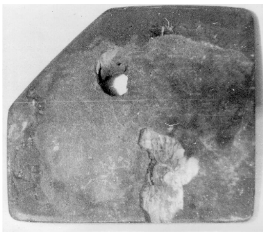
Рис. 2.22. Вид титанового элемента бронезилета без защитного слоя (отверстие вверху) и с защитным покрытием (скол внизу)
