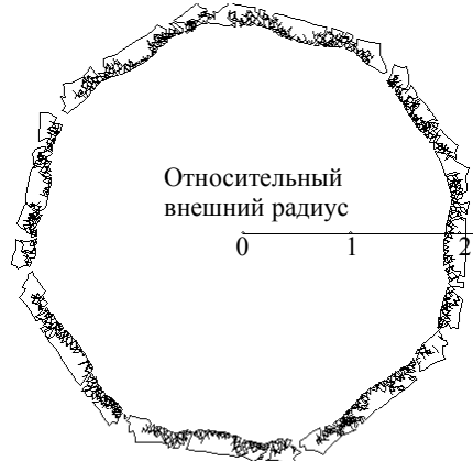
Рис. 4.29. Медная оболочка, подрезка на 50 %. Время t = 40 мкс
