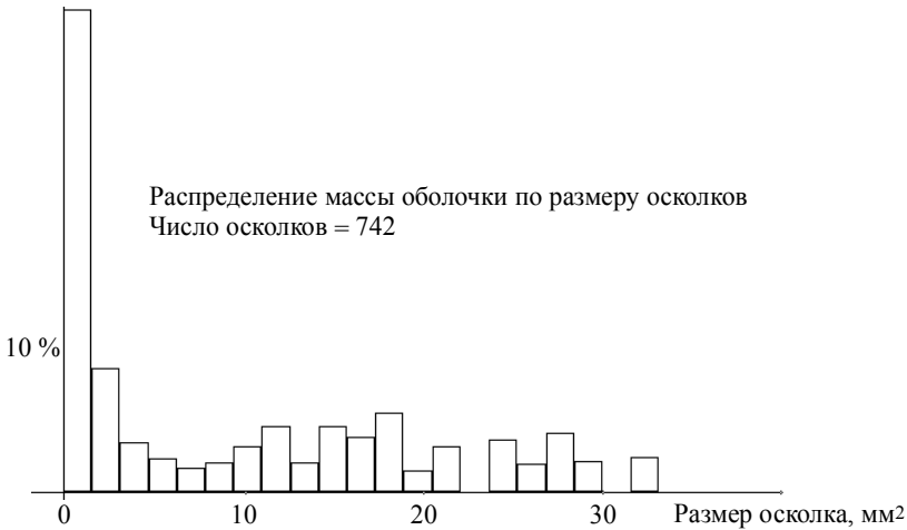
Рис. 4.17. Осколочный спектр. Время t = 32 мкс Распределение \varepsilon_{\max}^{\text{экв}} по экспоненциальному закону
