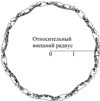
Рис. 4.28. Медная оболочка, подрезка на 30 %. Время t = 40 мкс
