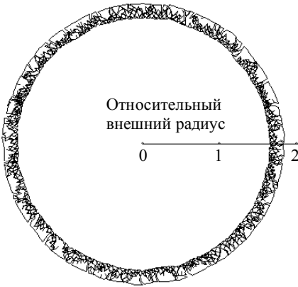
Рис. 4.14. Время t = 32 мкс. Распределение \varepsilon_{\max}^{\text{ЭКВ}} по вейбулловскому закону
