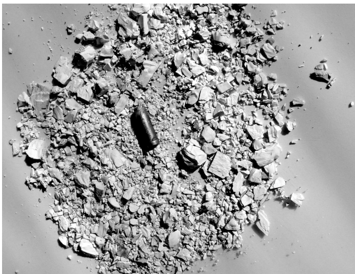
Рис. 2.23. Фрагменты разрушенного образца стеклокерамики и закаленный стальной сердечник пули (в центре) после испытания
