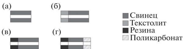
Рис. 5. Схема отсекающего устройства для ЛГУ МПХ 23/8 калибром 8 мм.
