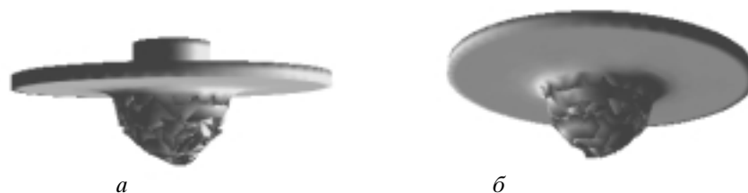
Рис. 9. Пробитие преграды оболочкой по нормали к поверхности ( t = 80 мкс): a – расчет с постоянными характеристиками материала, б – вариант с учетом вероятностного характера распределения физико-механических характеристик материала.
