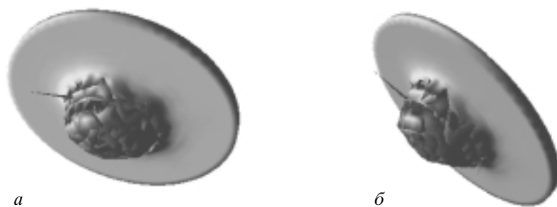
Рис. 10. Пробитие преграды оболочкой под углом к поверхности ( t = 80 мкс): a – расчет с постоянными характеристиками материала, б – вариант с учетом вероятностного характера распределения физико-механических характеристик материала.
