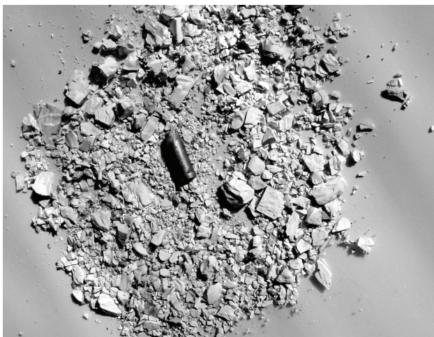
Рис. 2.21. Фрагменты разрушенного образца стеклокерамики и закаленный стальной сердечник пули (в центре) после испытания
