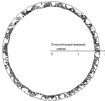
Рис. 4.31. Распределение \epsilon_{\text{мах}}^{\text{ЭКВ}} по нормальному закону в интервале 4E = 20\%x_0 . Время t = 32 мкс
